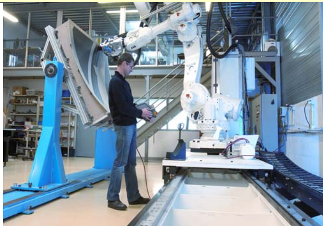
Machine de drapage de composites dans l'une des entreprises du pôle EMC 2.
